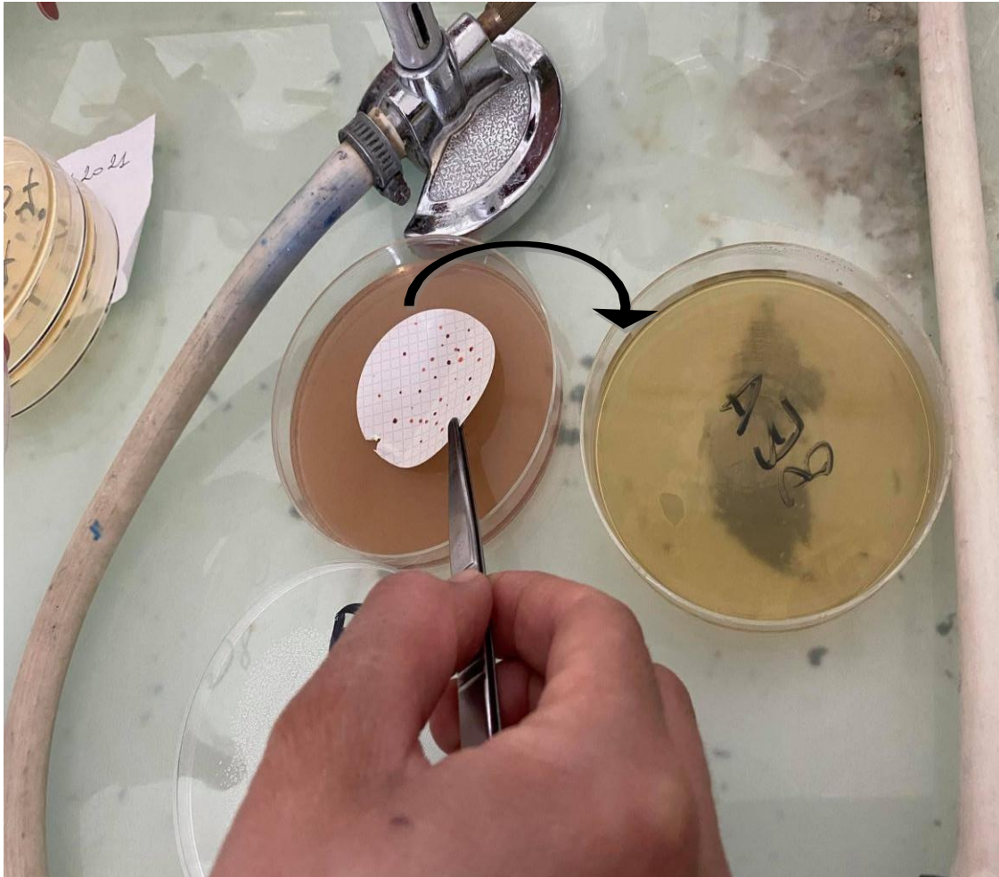
Figure 12 : Transfert de la membrane du milieu Slanetz au milieu de confirmation de la présence des streptocoques BEA.
